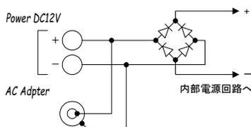
図15. 本体ACアダプタ・DC12V電源入力部の回路構成
