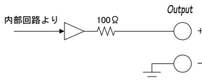
図 13. 本体出力部の内部回路構成
