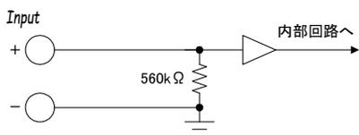
図 10. 本体入力部の内部回路構成
