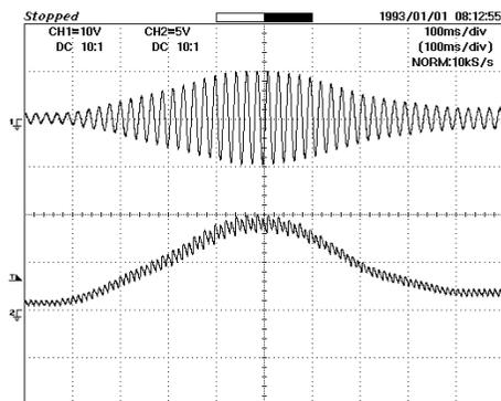
図3. エンベロープ回路の入出力波形
