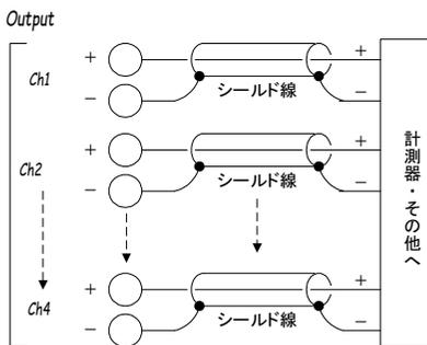
図 11. 個別シールドを使用した出力部の結線
